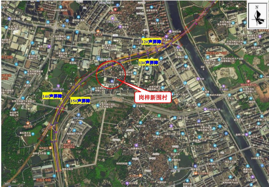
图 5.2-39 本项目顺接的环莞三期（莞番高速共线段）沿线隔声屏障设置示意图
